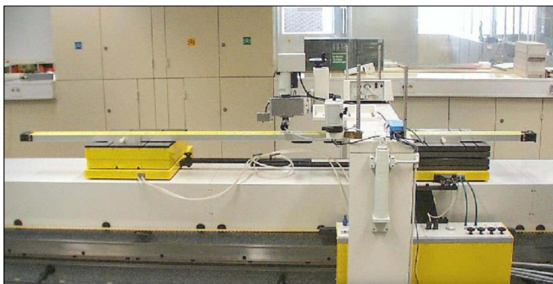
Fig. 3. Horizontal comparator for calibration (Universitat der Bundeswehr Munchen)[14].
